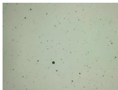
薄膜照射強度  $3 \times 10^{19} \text{W/cm}^2$  における陽子線生成数は  $10^9/\text{pulse/sr}$  であり、このとき  $\text{Li}(p, \alpha)\text{He}$  反応により約  $500/\text{sr/pulse}$  のアルファ粒子が生成され、 $70\text{mm} \times 1\text{mm}$  のCR-39で50個/100shotsが検出されると推定される。測定されたアルファ粒子ピットは48で、ほぼ予測どおりの値を得た。
