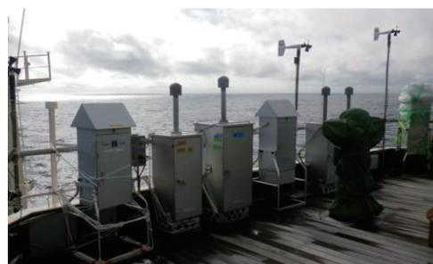
Fig.2 白鳳丸ブリッジ上に設置したエアサンプラー(左から2つ目)
