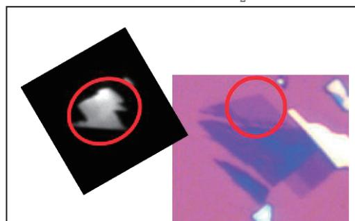
図 1 : シリコン基板上に剥離法で形成された  $\text{MoS}_2$  の発光イメージ (左) と光学反射イメージ (右)
