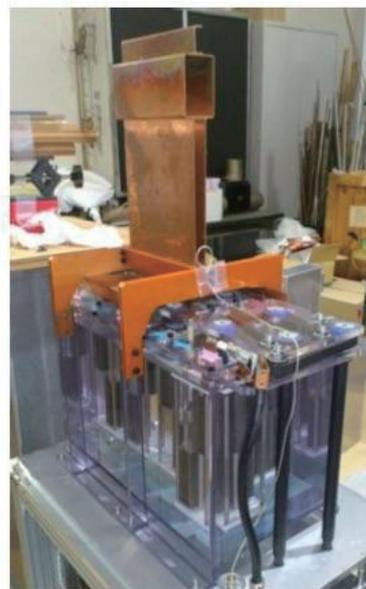
図 1 : 改良 Rebuncher
